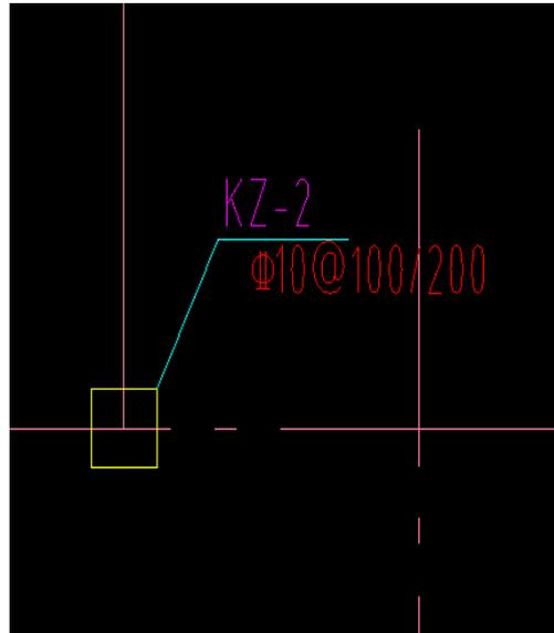
左边为柱大样图，右边为柱平面图中其中一根柱的箍筋标注，软件不能处理，看看同类软件怎么处理，见下图：
