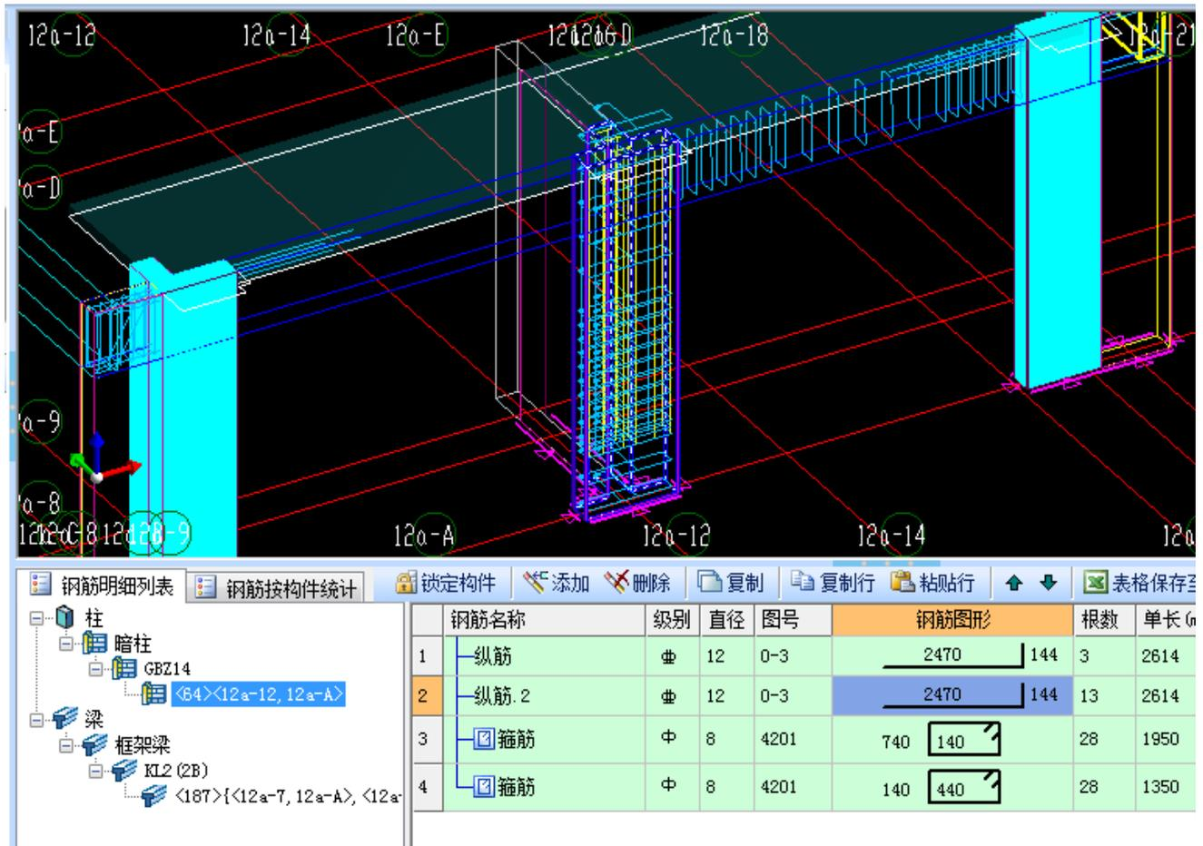
14. 钢筋软件在单个构件查量后点到列表里面的钢筋，同时钢筋三维显示计算公式并可以修改，如广联达
