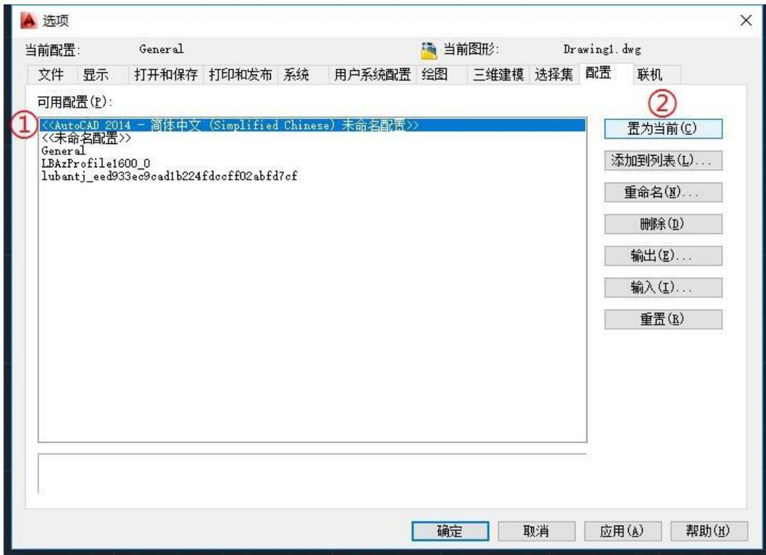
图 2.1 切换 CAD 至默认配置操作示意图
